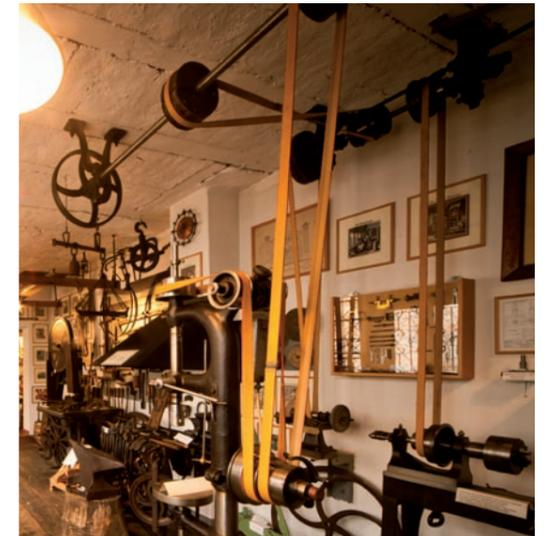
Transmission mit Ständerbohrmaschine; beim Bau der Werkstatt 1892 wurde der Transmissionsantrieb mit eingebaut
