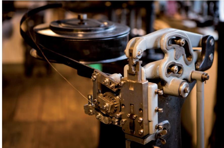
Bild links: Lederpresse zum Gefügmachen des Leders
